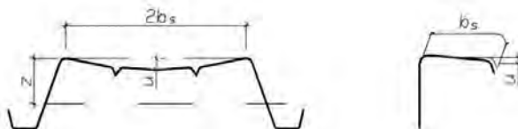
Figura C4.2.25 –Incurvamento delle piattabande
