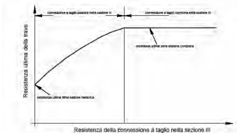
Figura C4.3.5 – Legame tra resistenza della trave e resistenza della connessione
